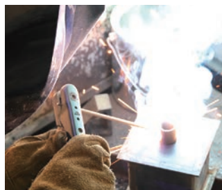
溶接压力容器製作
